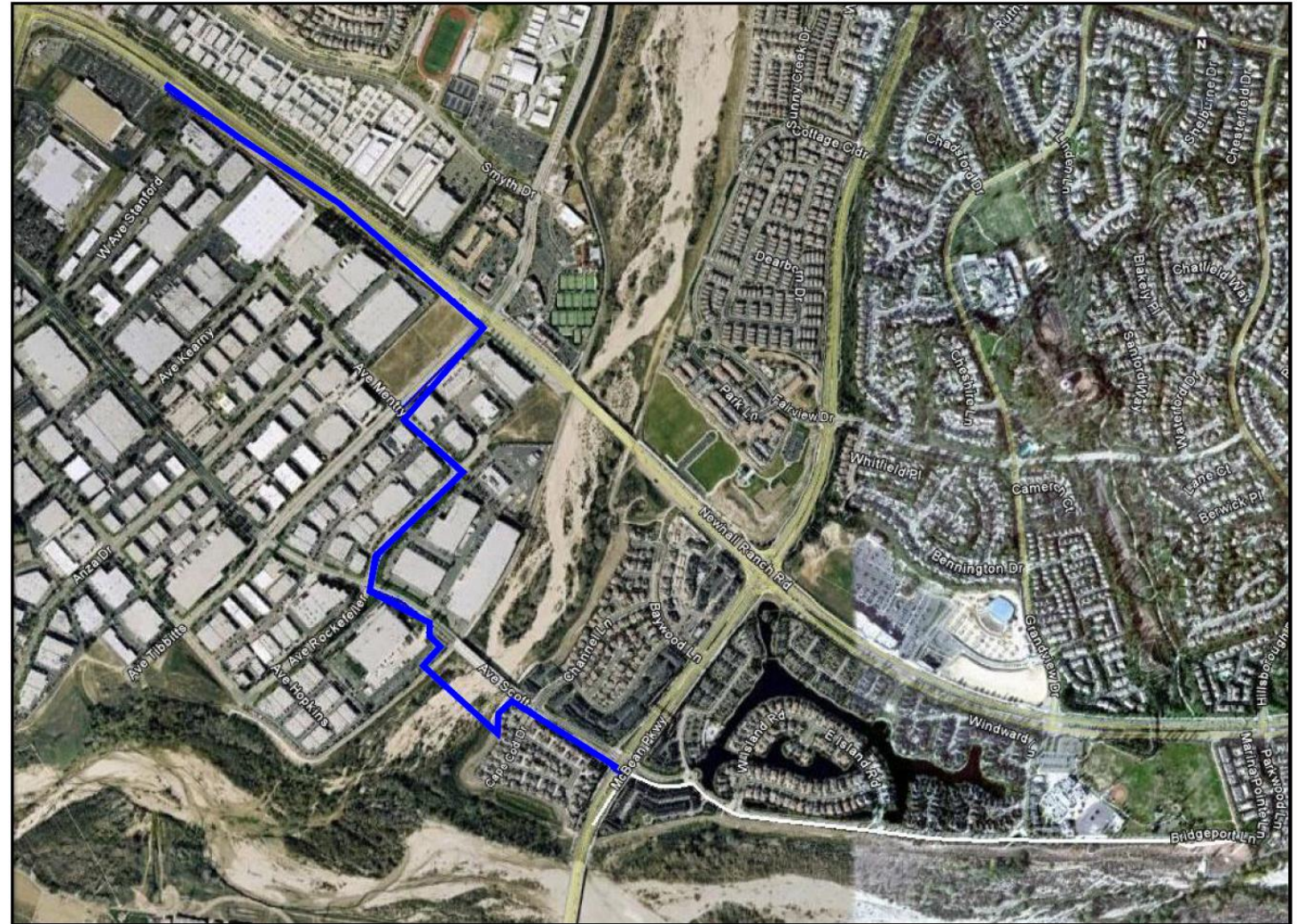
Castaic Conduit Pipeline Alignment
